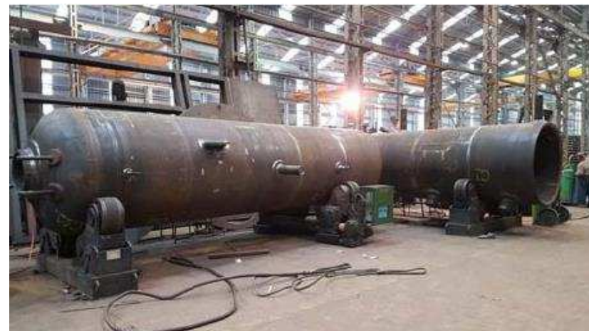
05/08/17 – Caldera en construcción (planta del proveedor Ricca)
